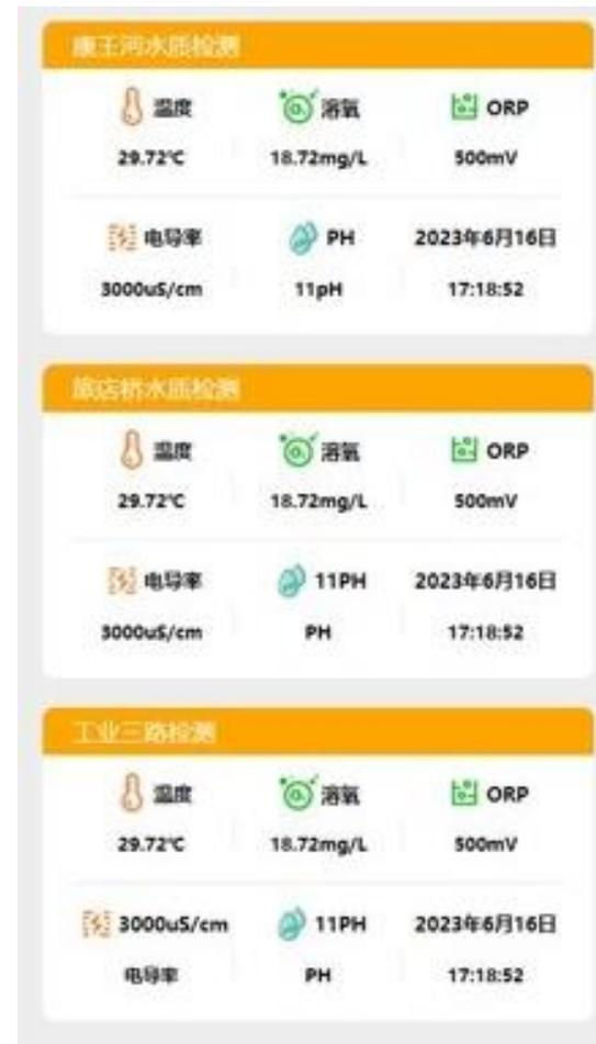
系统实时采集监测温度、湿度、气压、风速、风向、降雨量等气象检测数据；水质的溶氧度、电导率、ORP、PH值、流速等水质检测数据。对检测值异常信息进行预警。实时监控重点区域视频监控。
