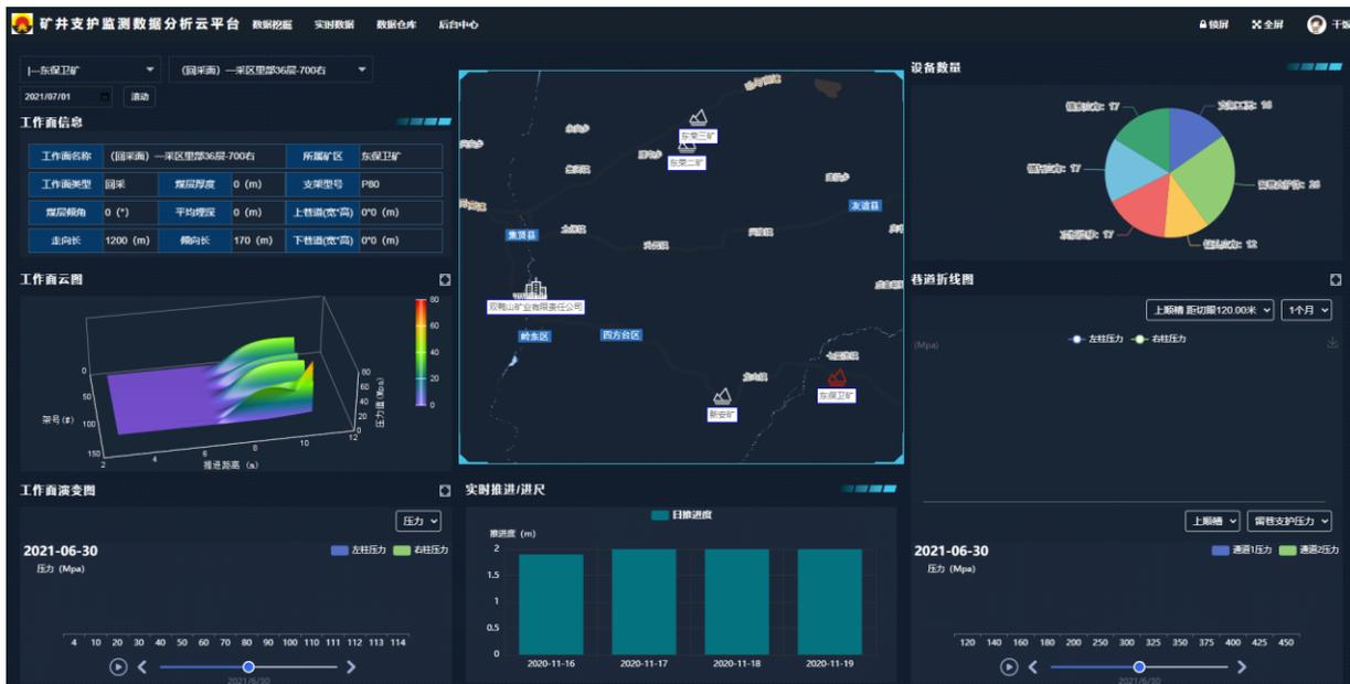
矿井掘进开采过程中支护位移、压力等数据监测分析平台。
