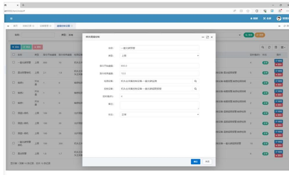
系统自动采集电机振动、压力、一氧化碳、光纤温度、烟感等终端设备数据，达到预警阈值自动预警并根据业务逻辑控制球阀设备、电机等设备。
